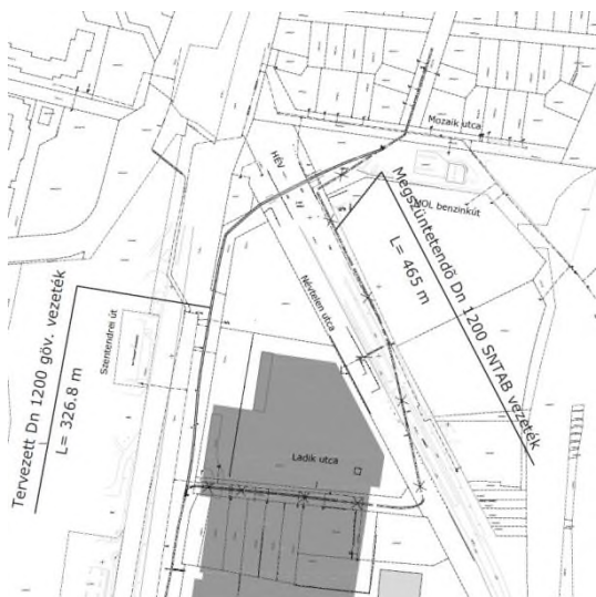
ÁTNÉZETI HELYSZÍNRAJZ Ladik utcai DN 1200 SENTAB vízvezeték kiváltása DN 1200 göv. csőből forrás: Kő-Pé-Terv Kft. 2011. 09.030.
